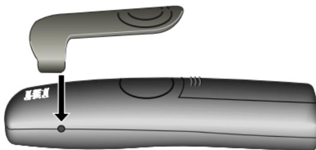
Установите зажим на задней стороне переносного телефона и нажимайте на него, пока боковые выступы не зафиксируются в углублениях.
